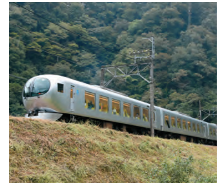
球面のような先頭のデザインや大きな窓が特徴的な特急「Laview」。インテリアはかつての「西武鉄道の黄色い電車」をイメージ
